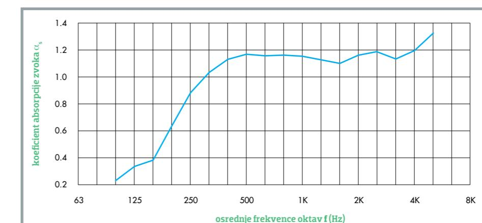
Graf prikazuje odvisnosti merjenega koeficiente absorpcije  $\alpha_s$  v odvisnosti od frekvenčnega spektra za mineralno volno z upornostjo zračnemu toku 5 kPa·s/m<sup>2</sup> pri debelini 75 mm.
