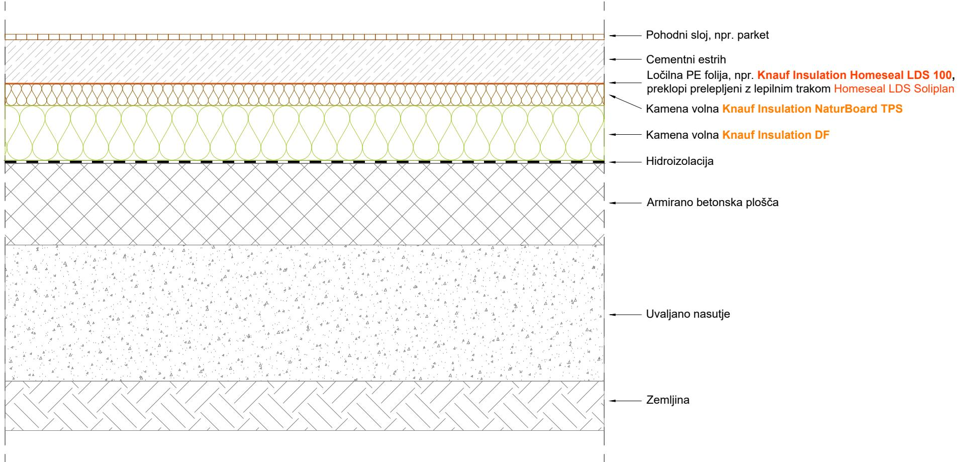
Toplotna in zvočna izolacija plošče na terenu:
