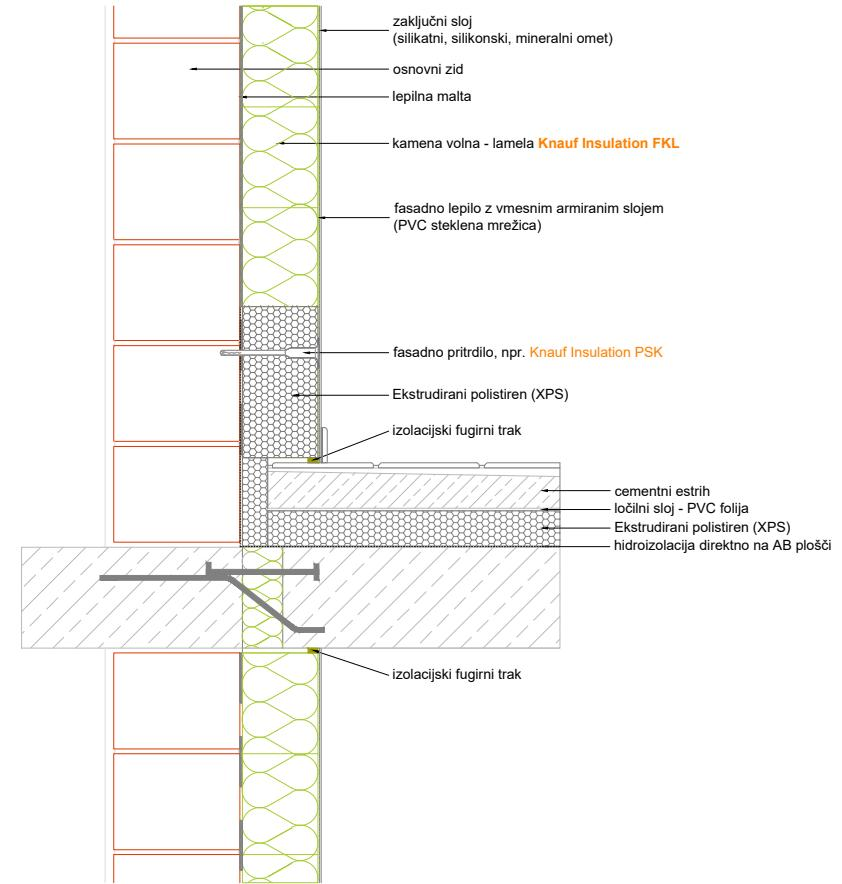
**Kontaktna fasada s ploščami ali lamelami iz kamene volne:
