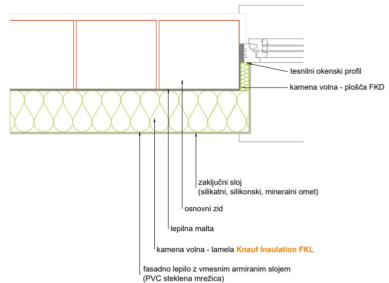
Kontaktna fasada s ploščami ali lamelami iz kamene volne:
