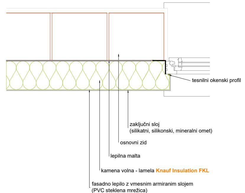
Kontaktna fasada s ploščami ali lamelami iz kamene volne:
