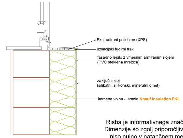
Kontaktna fasada s ploščami ali lamelemi iz kamene volne:
